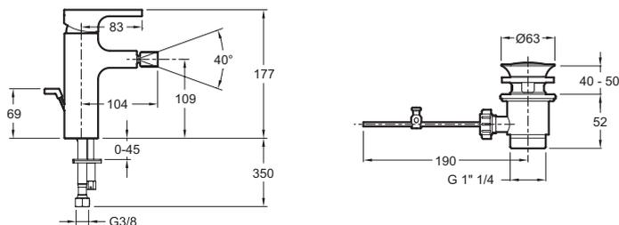
Спецификация продукта: Однорычажный смеситель для биде. E98338. Коллекция: STRAYT. ВЕС: 2,6 кг. ТИП УСТАНОВКИ: 1 отверстие. ТИП: Однорычажный. РАСХОД ВОДЫ: 5 л/мин. ВЫСОТА ПОД ИЗЛИВОМ: 109 мм. РАССТОЯНИЕ МЕЖДУ ЦЕНТРОМ ИЗЛИВА И ЦЕНТРАЛЬНОЙ ОСЬЮ КОРПУСА: 104 мм. ПОДКЛЮЧЕНИЕ: С гибкой подводкой. МЕХАНИЗМ: Кран-букса с керамическим диском. СЛИВ: С донным клапаном. ОДНОРЫЧАЖНЫЙ СМЕСИТЕЛЬ: 0. УСТАНОВКА: 1 отверстие. ГАРАНТИЯ НА ОТДЕЛКУ: 10 лет.
